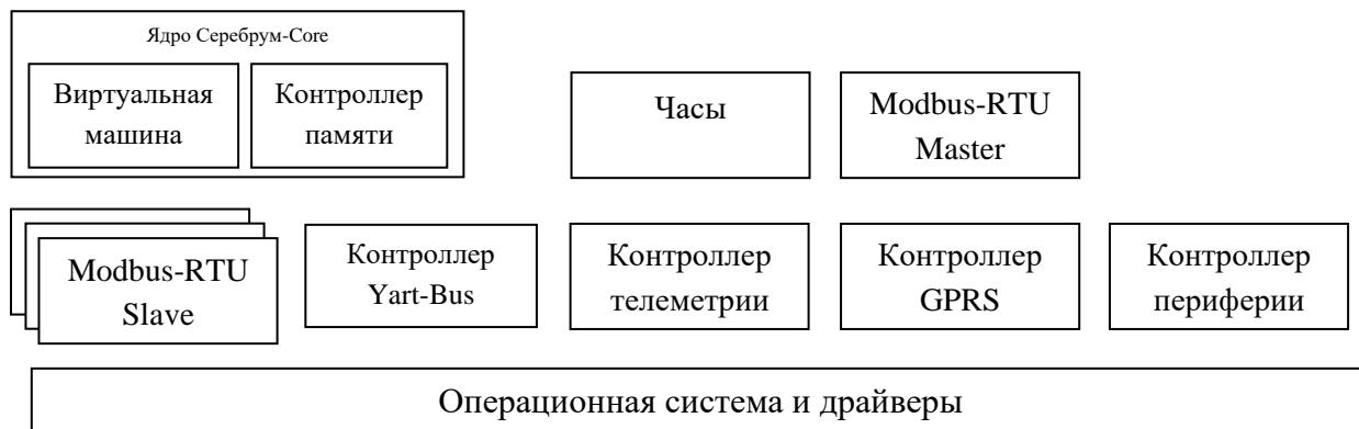
Рисунок 9. Архитектура контроллера COBALT
