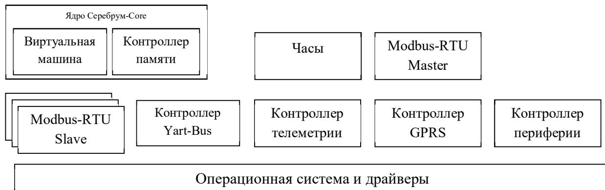
Рисунок 9. Архитектура контроллера COBALT
