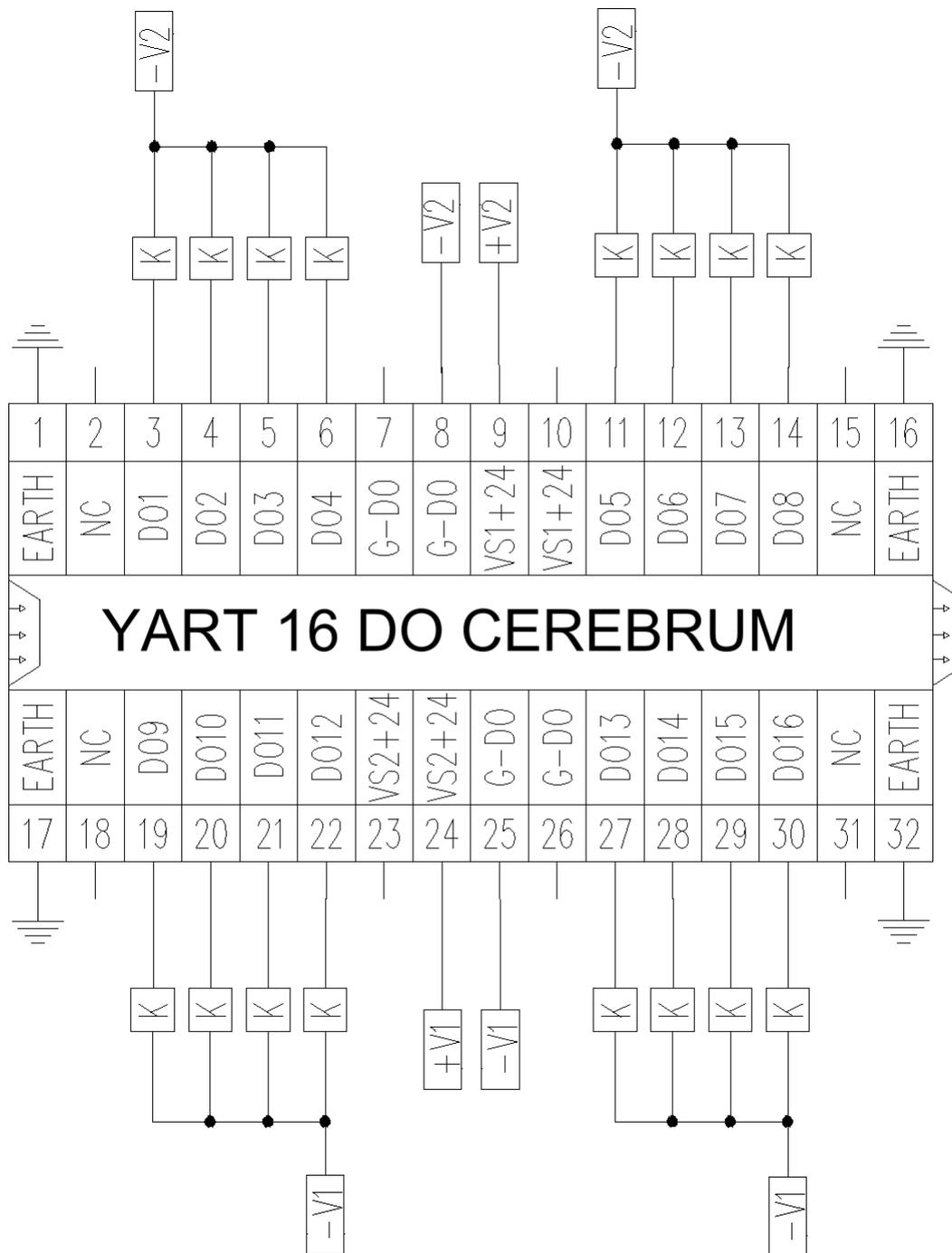
Цепи питания дискретных выходов VS1+24 и VS2+24 на верхней и нижней клеммных колодках изолированы друг от друга и питают отдельно каждую из сторон. Т.е. дискретные выходы на верхней колодке запитаны от VS1+24, на нижней – от VS2+24. Цепь G-DO – общая для всего модуля.
