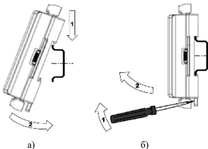
Рисунок 5 – Последовательность действий при выполнении монтажа и демонтажа модуля расширения
