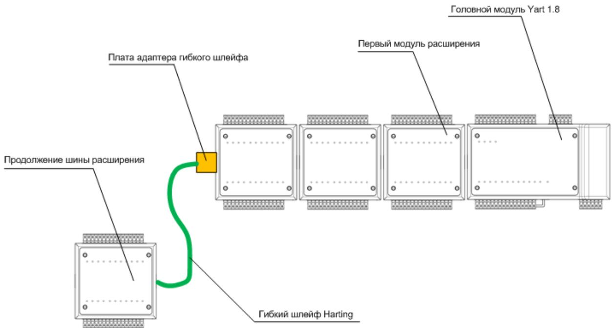
Рисунок 2 – Подключение модулей расширения к контроллеру
