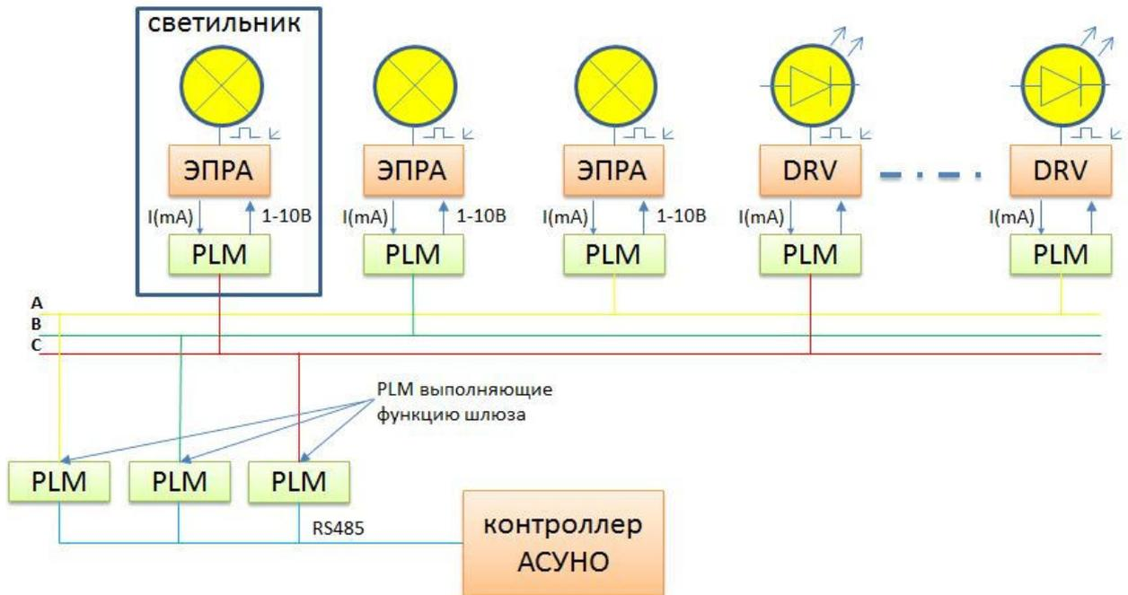
Рисунок 2 – Пример при организации сети PLM-2000 для уличного освещения
