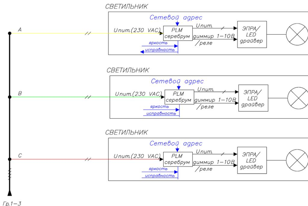
Рисунок 3 – Схема подключения устройств при организации сети PLM-2000 для уличного освещения
