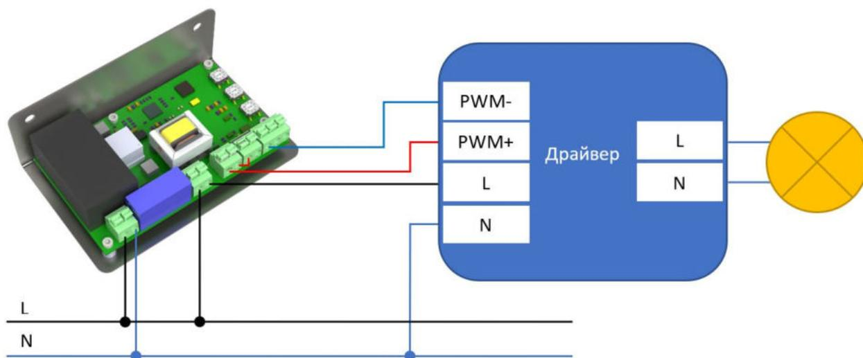
Рисунок 4 А – Подключение устройства при управлении ШИМ
