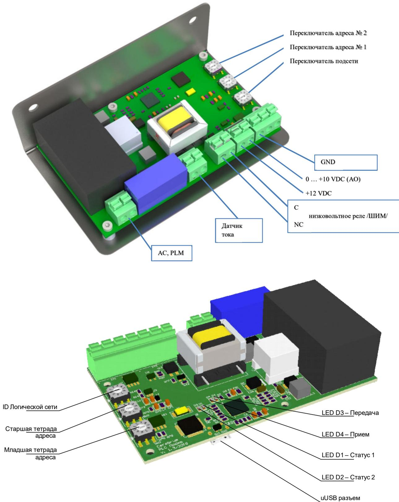
Рисунок 1 – Внешний вид устройства
