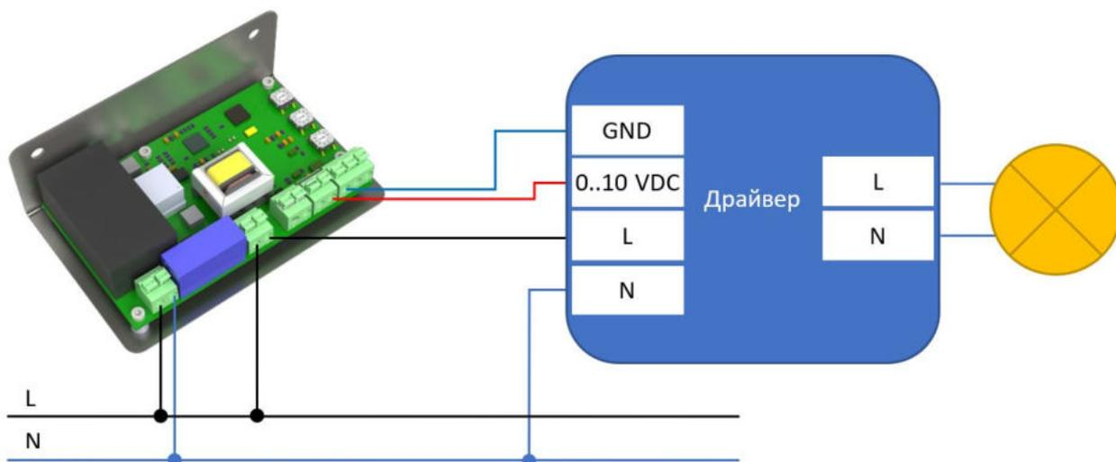
Рисунок 4 Б – Подключение устройства при управлении 0..10 В
